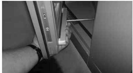
Kuulapää vapautuu lukituskannasta irrotusnappia painamalla.
