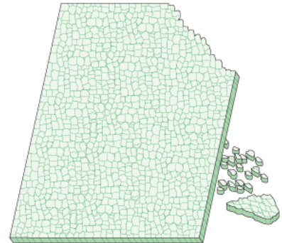
Karkaistu turvalasi sen sijaan murenee pieniksi, vaarattomiksi lasimuruiksi.
