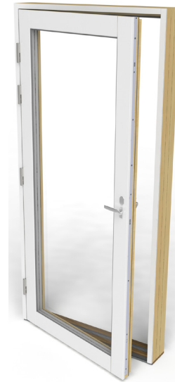
Parveke KK-oven sisäpuoli on puuta, ulkopuolella säältä suojaava alumiiniverhous. Sisäpuolen karmissa (karmit 170 ja 210 mm) keventävä viiste.
